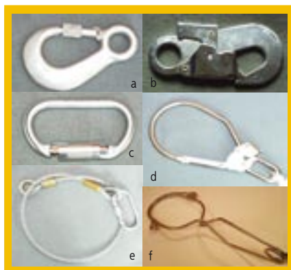
Fot. 1. Przykłady podzespołów kotwiczących: a – zatrzaśnik typu „hak” z ręczną blokadą (korpus ze stopu aluminium), b – zatrzaśnik typu „hak” z samoczynną blokadą (korpus ze stali), c – zatrzaśnik owalny z automatyczną blokadą ramienia, d – zatrzaśnik kotwiczący, e – zaczep linkowy, f – zaczep nożycowy
