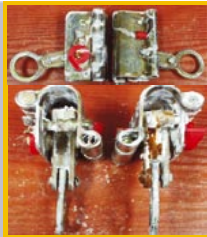
Fot. 7. Korozja mechanizmów urządzeń samozaciskowych poddanych kondycjonowaniu we mgle neutralnego chlorku sodu (metoda NSS). Widoczne skutki korozji cynkowej warstwy ochronnej – nalot białoszary oraz korozji podłoża – nalot rudobrazowy
