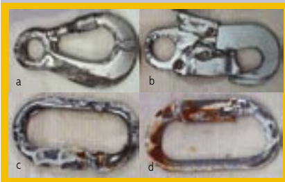
Fot. 5. Zatrzaśniki poddane działaniu środowiska korozyjnego (rozpylonej mgły neutralnego chlorku sodu – metoda NSS): a – zatrzaśnik typu „hak” z ręczną blokadą (korpus ze stopu aluminium), b – zatrzaśnik typu „hak” z samoczynną blokadą (korpus ze stali), c – zatrzaśnik owalny ze stali z ręczną blokadą, d – zatrzaśnik owalny ze stali z automatyczną blokadą
