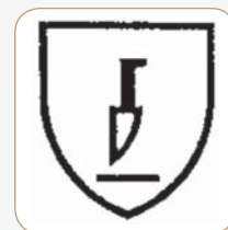
Rys. 5. Znak graficzny oznaczający ochronę przed ułciami i przecięciami nożami ręcznymi wg EN 1082-1:1996 [7]
