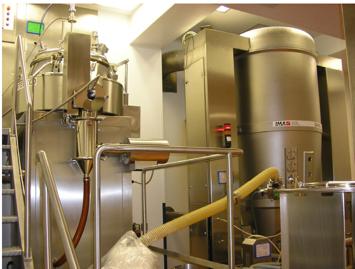
Rys. 5. Urządzenie do granulowania i suszenia masy tabletkowej
