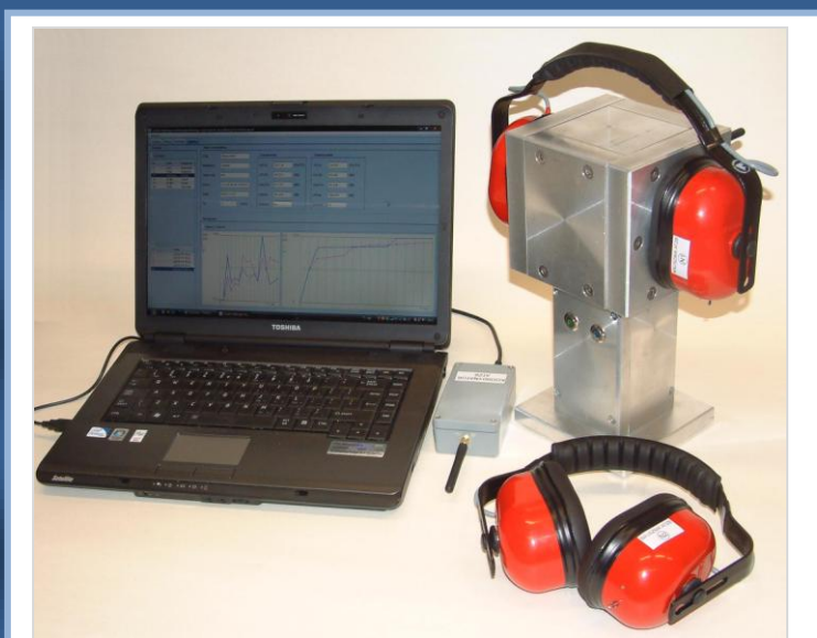
Rys. 3. System zdalnego nadzoru użytkowania nauszników przeciwhałasowych (układ modelowy).
