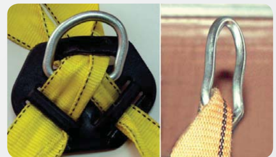
Fot. 8. Przykłady deformacji metalowych klamer zaczepowych
