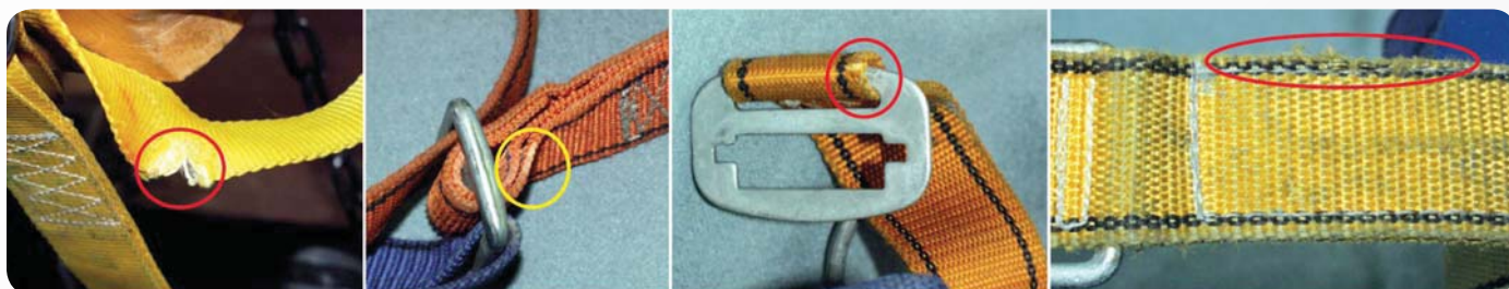
Fot. 3. Przykłady uszkodzeń mechanicznych taśm włókienniczych Fig. 3. Examples of mechanical damages to webbing
