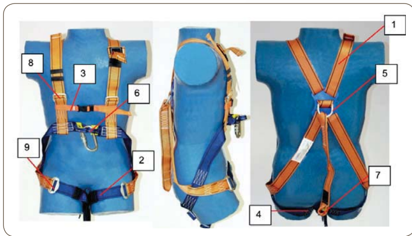
Fot. 1. Typowa konstrukcja szelek bezpieczeństwa: 1 – pas barkowy, 2 – pas udowy, 3 – pas piersiowy (pomocniczy), 4 – „siodełko”, 5 – zaczep grzbietowy, 6 – zaczep piersiowy, 7 – łącznik zaczepu grzbietowego, 8 – kłamra regulacyjna pasa barkowego, 9 – kłamra spinająco-regulacyjna pasa udowego
