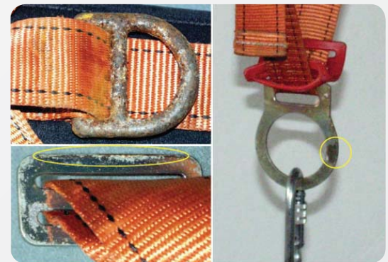
Fot. 7. Przykłady korozji metalowych klamer szelek bezpieczeństwa
