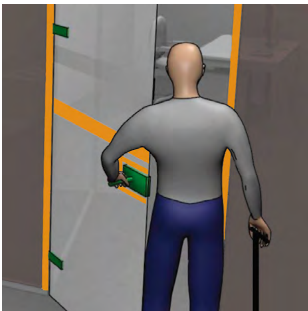
Rys. 6-14. Dostosowanie siły niezbędnej do otwarcia drzwi z samozamykaczem do możliwości osób z niepełnosprawnością pozwala na swobodne ich otwieranie (źródło: CIOP-PIB)
