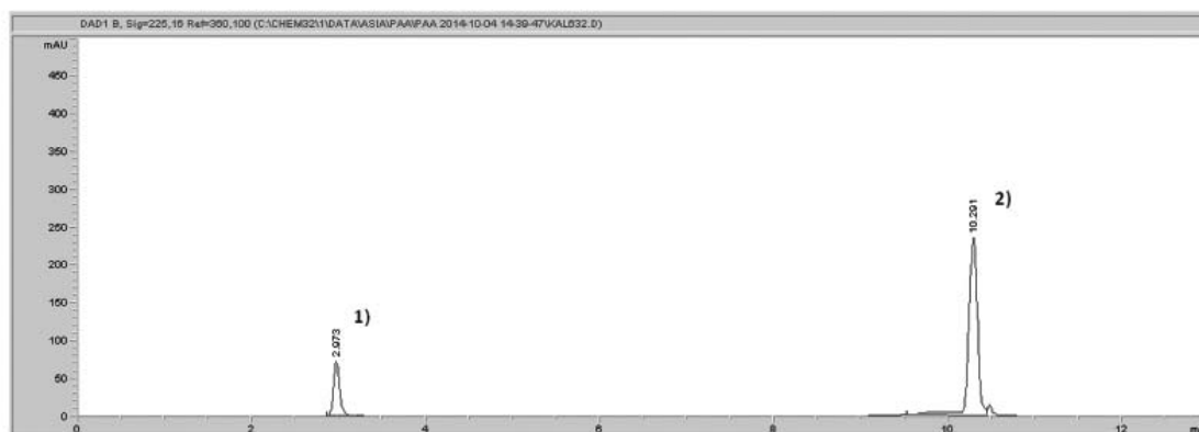
Rys. 6. Chromatogram roztworu wzorcowego zawierającego: 1) sulfotlenek metylowo- p -tolilowy (MISO) i 2) nieprzereagowany sulfid metylowo- p -tolilowy (MTS). Kolumna Ultra C18, detektor DAD (225 nm)
