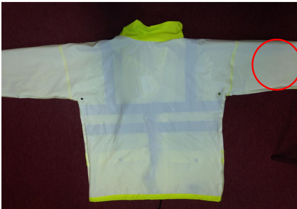
Rysunek 4 Ustalenie pozycji pierwszego nastrzyknięcia na odzież
