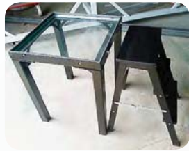
Rys. 2. Podest do skanowania stóp za pomocą skanera ręcznego 3D
