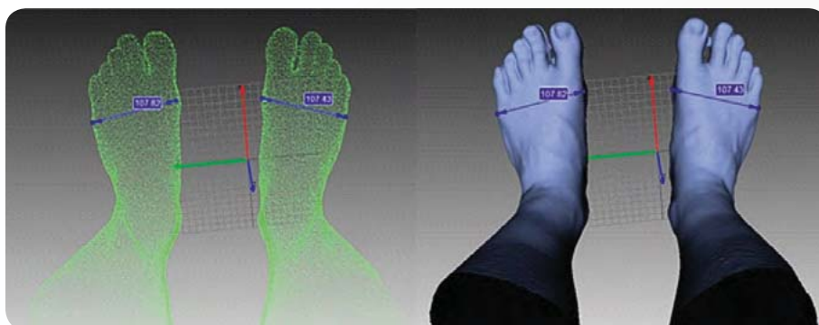
Rys. 14. Wyznaczanie szerokości przodostopia na podstawie obrazu 3D stopy
