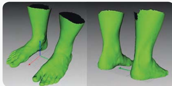
Rys. 10. Przykładowe obrazy stóp i sposób wyznaczania linii, uzyskane z wykorzystaniem skanera ręcznego 3D i wspomagającego oprogramowania komputerowego
