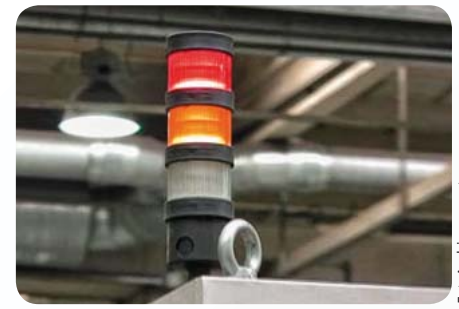
Fot. 3. Fragment obudowy lasera przemysłowego z zamontowanym elementem do sygnalizacji świetlnej Photo 3. An element of the industrial laser housing with the installed element for signal lights
