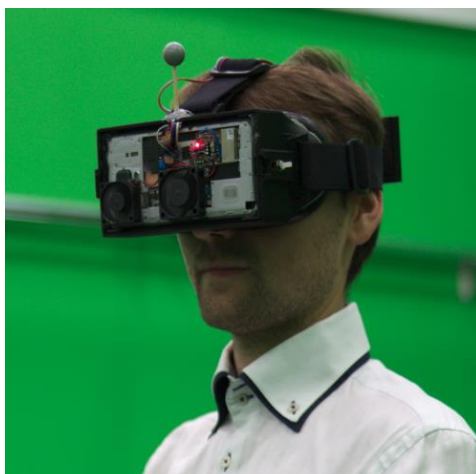
Rysunek 1. Bezprzewodowa gogle VR wykorzystywane w Laboratorium Zanurzeniowej Rzeczywistości Wirtualnej CIOP-PIB.
