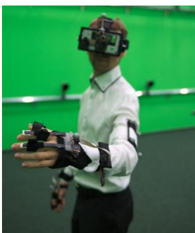
Rysunek 2. Bezprzewodowa rękawica VR wykorzystywana w Laboratorium Zanurzeniowej Rzeczywistości Wirtualnej CIOP-PIB.
