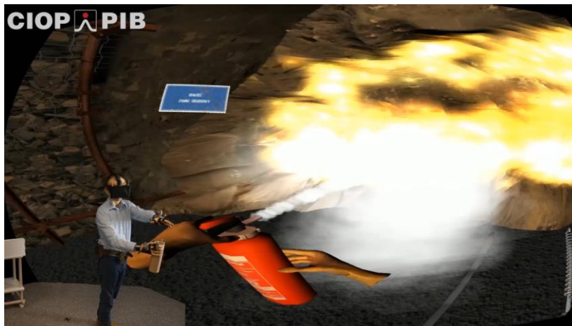
Rysunek 3. Przykład wdrożonej wirtualnej symulacji szkoleniowej obejmującej w swym zakresie m.in. gaszenia płonącej ścianki przodka w podziemnej kopalni węgla kamiennego. W symulacji wykorzystana jest atrapa rzeczywistego obiektu (gaśnicy)
