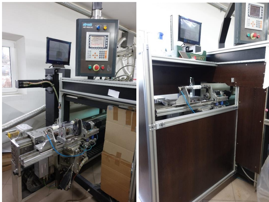
Fot. 5. Stanowisko pracy operatora wielokolorowej maszyny poligraficznej do sitodruku, a – przed modernizacją; b – po modernizacji
