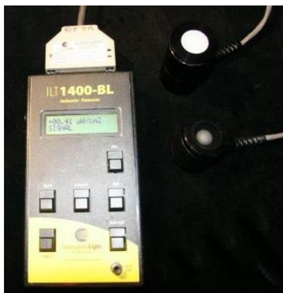
Fot. 1. Radiometr wraz z sondami pomiarowymi
