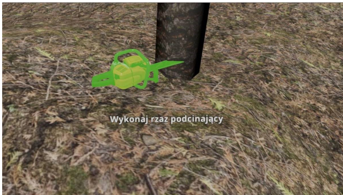
Rysunek 6. Podpowieź – awatar poruszający się jak piłarka przy poprawnym wykonaniu rżazu podcinającego
