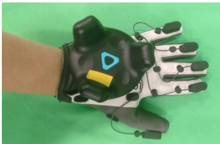
Rysunek 5. Rękawice Haptic symulujące siłowe sprzężenie zwrotne z trackerem mapującym położenie i rotację dłoni w przestrzeni
