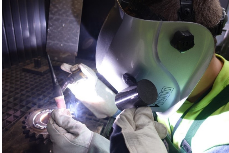
Rys. 7. Przykładowy pomiar zagrożenia promieniowaniem UV na stanowisku spawacza (fot. Autor)
