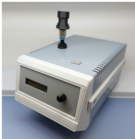
Fot. 1. Prototyp niskokosztowego miernika nanoobjektów w powietrzu Photo 1. A prototype of a low-cost nanoobject meter in the air
