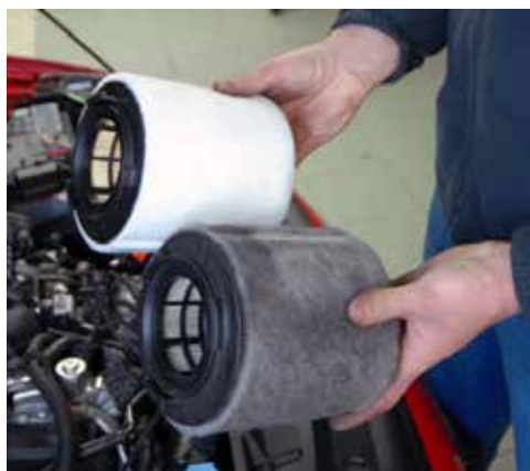
Fot. 2. Zanieczyszczone filtry pochodzące z samochodowej instalacji klimatyzacyjnej (algae/Bigstockphoto, smuay/Bigstockphoto)
