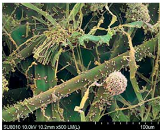
Fot. 9. Aspergillus spp. na włókninie filtracyjnej z układu klimatyzacyjnego samochodu osobowego (źródło własne)
