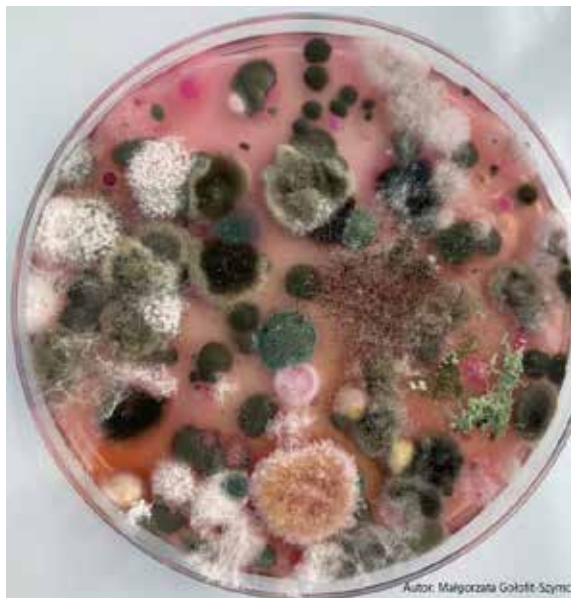
Fot. 8. Wzrost grzybów pleśniowych (izolacja z włókniny filtracyjnej) na podłożu agarowym z dichloranem, czerwienią bengalską i chloramfenikolem (DRBC) (źródło własne)
