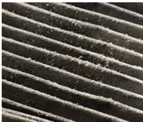
Fot. 2. Zanieczyszczone filtry pochodzące z samochodowej instalacji klimatyzacyjnej (algae/Bigstockphoto, smuay/Bigstockphoto)
