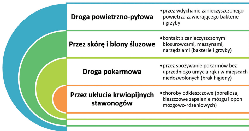
Rys. 1. Drogi rozprzestrzeniania się szkodliwych czynników biologicznych na stanowiskach pracy
