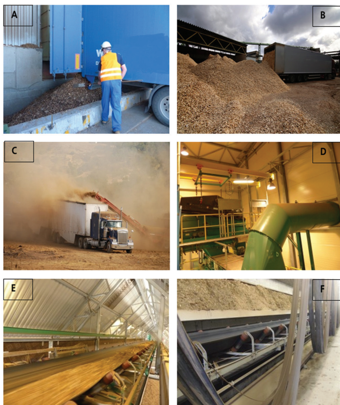
Rys. 2. Przykładowe stanowiska pracy związane z przetwarzaniem biosurowców: A i B – miejsce rozładunku biosurowców w elektrowniach, C – rozdrabnianie drewna i załadunek uzyskanych zrębów, D – hala sortowania i kruszenia biosurowców w elektrociepłowni, E i F – transport biosurowców na taśmociągu do magazynu (fot. A, D-F – CIOP-PIB, fot. C i B – bigstockphoto)
