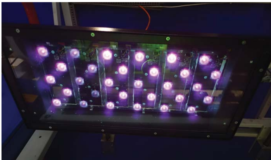
Fot. 5. Widok oprawy UV-LED zamontowanej na stanowisku obsługi defektoskopu magnetyczno-proszkowego
