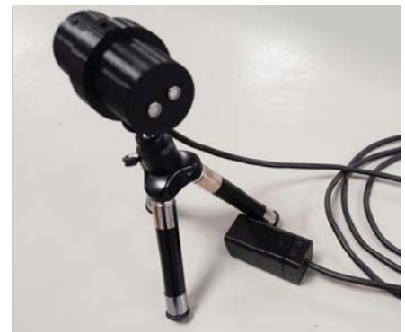
Fot. 2. Detektor pomiarowy na statywie z modulem zasilającym Photo 2. The measuring detector on a tripod with a power supply module
