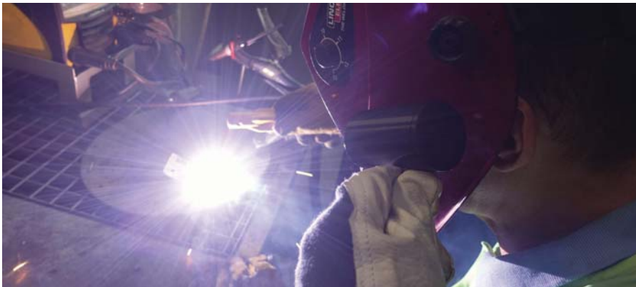
Fot. 3. Pomiar promieniowania UV przy wykorzystaniu opracowanego modelu mobilnego systemu pomiarowego na stanowisku spawacza – spawanie metodą MMA Photo 3. Measurement of UV radiation using a developed detector model to assess the risk of UV radiation at welding station – MMA welding
