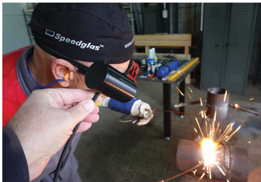
Fot. 4. Pomiar promieniowania UV z wykorzystaniem opracowanego modelu mobilnego systemu pomiarowego na stanowisku spawacza – spawanie gazowe Photo 4. Measurement of UV radiation using a developed detector model to assess the risk of UV radiation at welding station – gas welding
